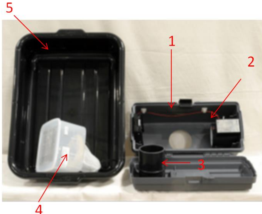
Figure 2: trappola tipo Gravid non assemblata.
